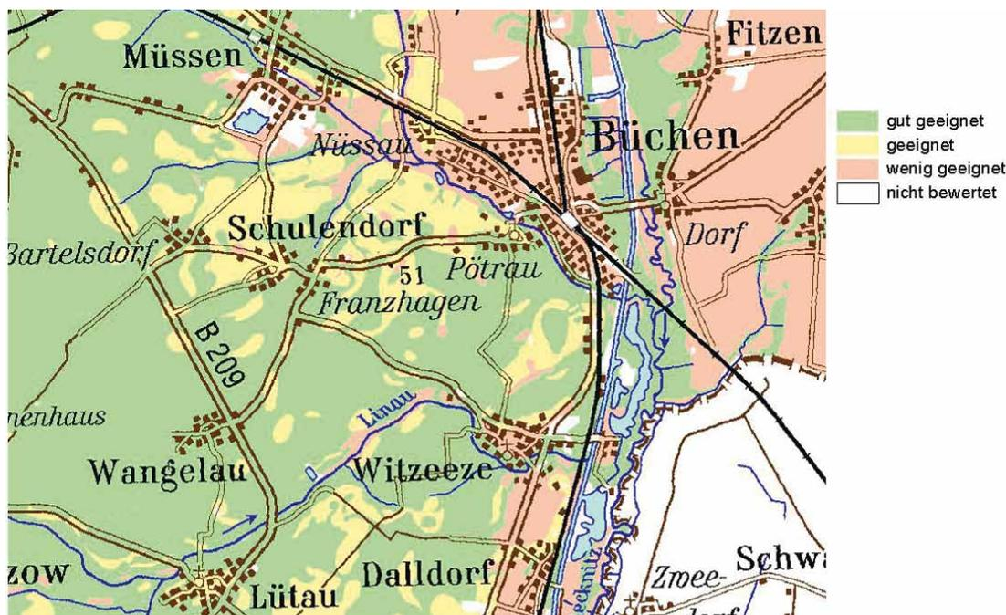
Abbildung 21: **Zur Orientierung bei kleinen Anlagen:** Die potenzielle Standorteignung für Erdwärmekollektoren wird über die Klassifikation der Wärmeentzugsleistung bewertet. Diese wiederum ist hier im Wesentlichen eine Funktion der Wärmeleitfähigkeit auf der Basis der bodenkundlichen Landesaufnahme Umweltatlas SH: [www.umweltatlas.schleswig-holstein.de](http://www.umweltatlas.schleswig-holstein.de)
